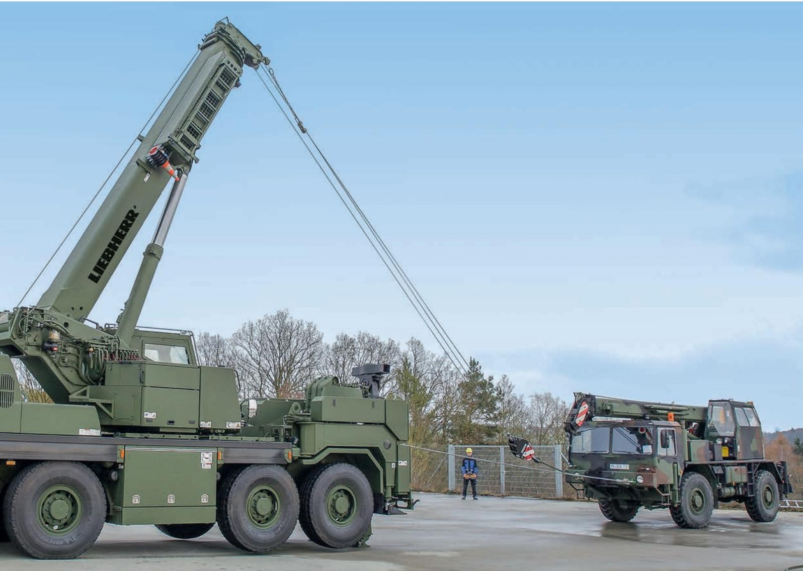
Mit dem Seil der Hubwinde über den eingefahrenen Teleskopausleger und dem Seil der 200 kN starken Bergewinde ist ein synchrones Ziehen möglich. So kann der Havarist bei diesem Bergvorgang etwas angehoben und gleichzeitig zur Abschleppereinrichtung gezogen werden.
